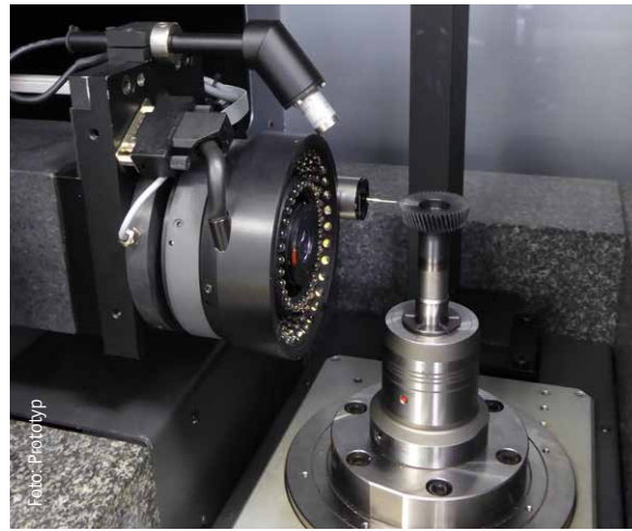
4 Wälzschälrad-Messung auf einem Werth-Multisensor-Messgerät, Mess- und Auswerte-Software: HAWK
